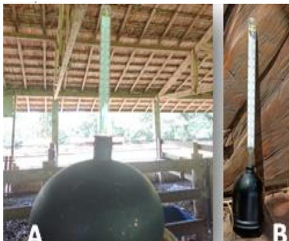
**Figura 1** - A- Globo de Vernon, instrumento padrão disponível no mercado; B- Globo negro alternativo, caneca de alumínio utilizada em pistola de pintura, pintada de preto fosco.
